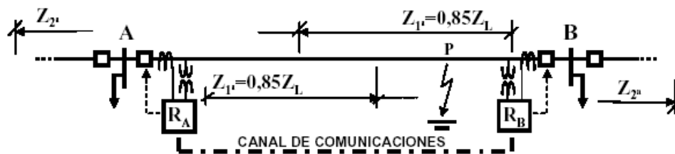
Fig. 9.5.2.1 Funcionamiento protección de distancia con subalcance permisivo
